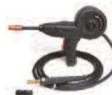
Diseñada para carretes de 4in (102mm) carretes de 1lb(0.45kg) de .030"(0.8mm) o 0.035"(0.9mm) de diámetro de micro alambre de aluminio SuperGlaze®. Incluye pistola, kit de adaptación, tres puntas de contacto de 0.035"(0.9mm), difusor de gas y un carrete de 1lb(0.45kg) de alambre SuperGlaze® 4043 de 0.035"(0.9mm).
